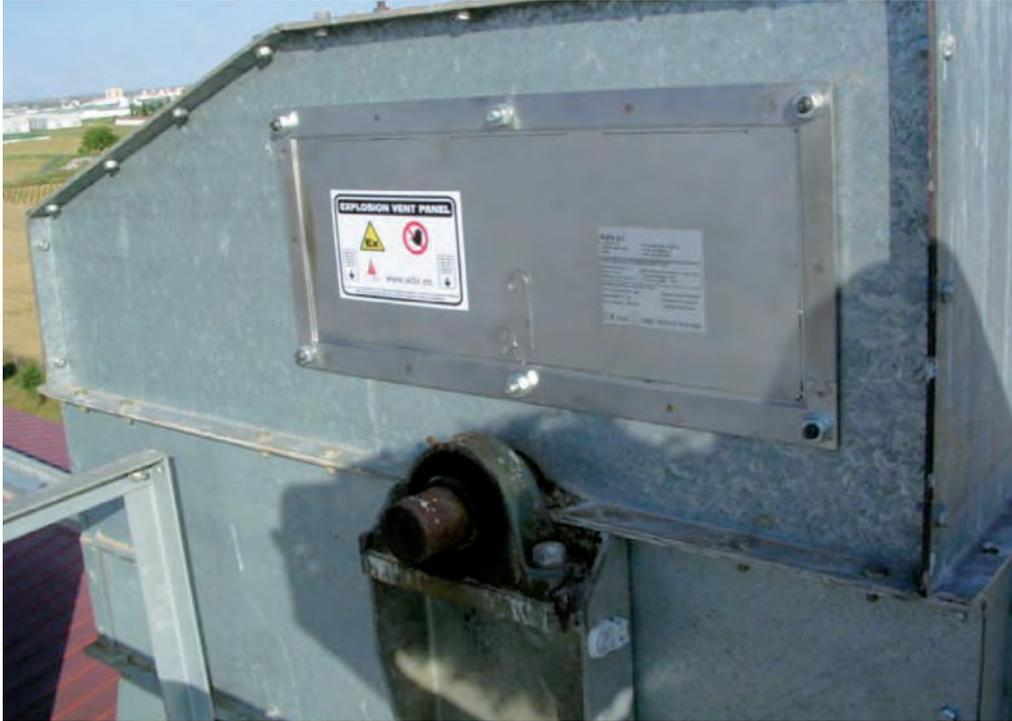
**ILUSTRACIÓN 21.** Montaje de venteo en elevador de cangilones
