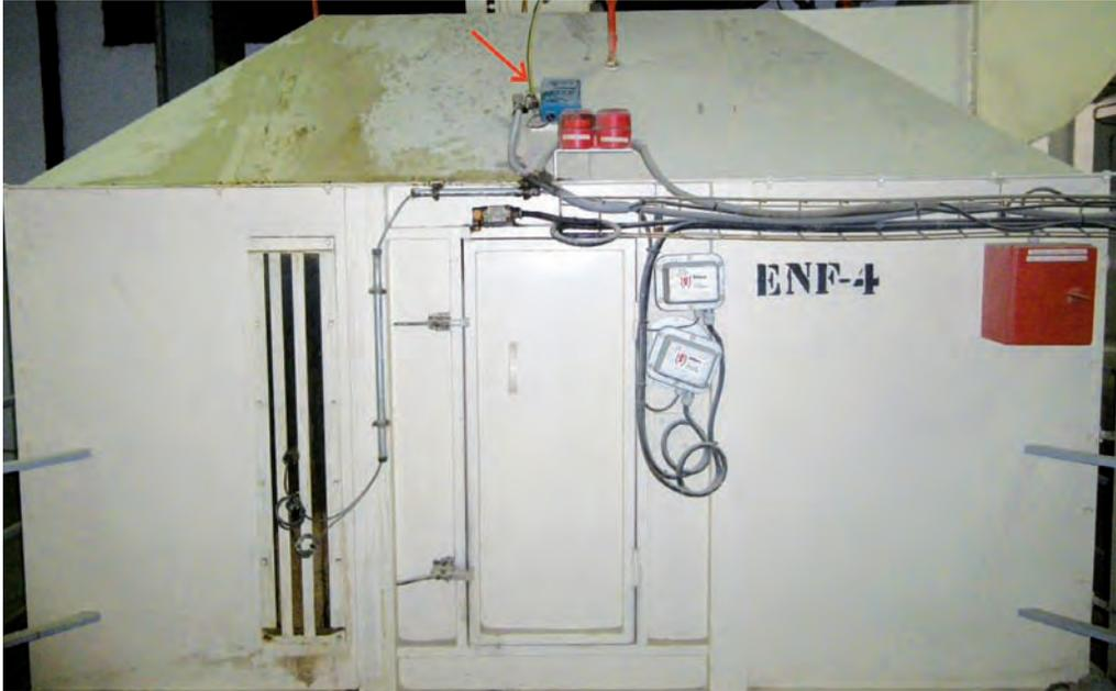
**ILUSTRACIÓN 14.** Equipo detección chispas en enfriador
