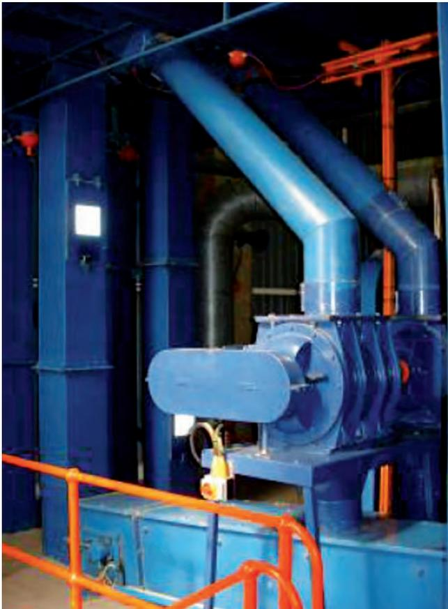
*ILUSTRACIÓN 26. Válvulas rotativas certificadas para aislamiento de explosión*
