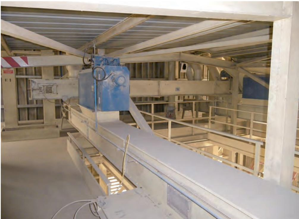
**ILUSTRACIÓN 5.** Aspiración localizada en transportador de cadena
