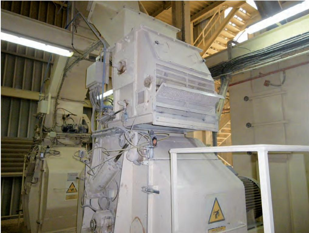
*ILUSTRACIÓN 17. Sistema de limpieza de cuerpos extraños en alimentador de molino (Por cortesía de Nanta)*
